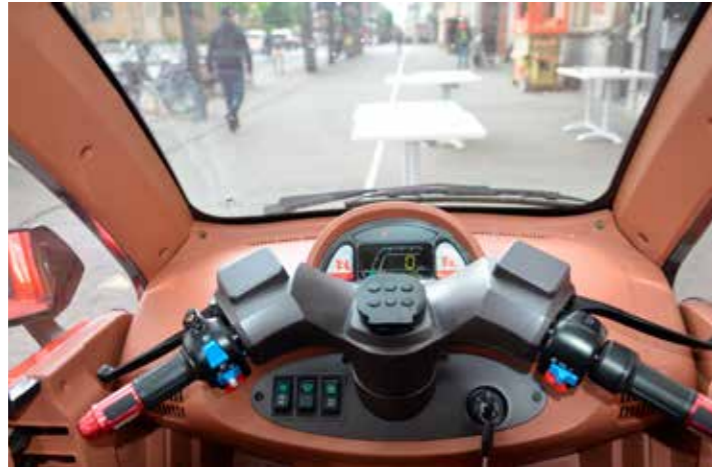
Sturen doe je met een 'gewoon' scooterstuur in deze trike
